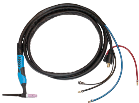
108 698 uchwyt spawalniczy TIG 18 DX50 4 m 108 699 uchwyt spawalniczy TIG 18 DX50 8 m (uchwyty chłodzone cieczą) wtyczka sterowania 5-PIN (103 687) przyłącze gazu - króciec typ 21 (103 756) przyłącza cieczy (2szt.) - króciec typ 21 (103 756)
