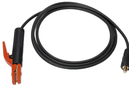
107 324 przewód spawalniczy MMA MT 400 350A / 25 mm 2 L=3 m / DX50 107 326 przewód spawalniczy MMA MT 500 500A / 35 mm 2 L=3 m / DX50
