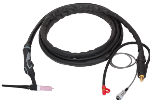
104 432 uchwyt spawalniczy PARWELD PROFI TIG 17 DX50 4m UP/DOWN skóra (1m) ze zdalnym sterowaniem w ręcznie wtyczka sterowania 5-PIN (102 763) przyłącze gazu - króciec typ 21 (103 756)
