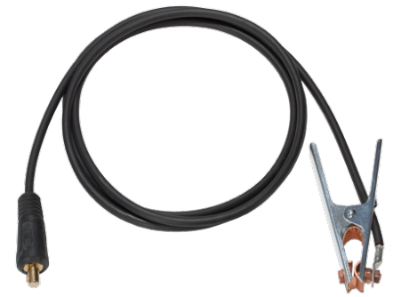
107 327 przewód masowy HL 6008 200A / 16 mm 2 L=3 m / DX25 107 328 przewód masowy HL 6018 300A / 25 mm 2 L=3 m / DX50 107 329 przewód masowy HL 6007 500A / 35 mm 2 L=3 m / DX50
