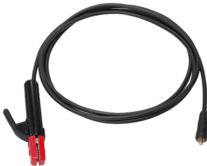
107 322 przewód spawalniczy MMA YDL 200 200A / 16 mm 2 L=3 m / DX25 107 323 przewód spawalniczy MMA MT 300 250A / 25 mm 2 L=3 m / DX50
